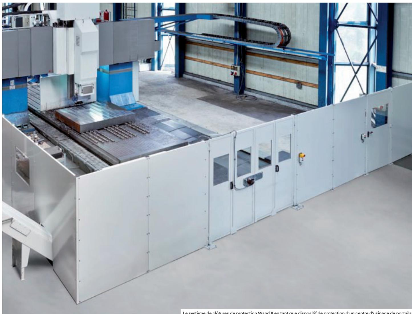
Le système de clôtures de protection Wand II en tant que dispositif de protection d'un centre d'usinage de portails.
