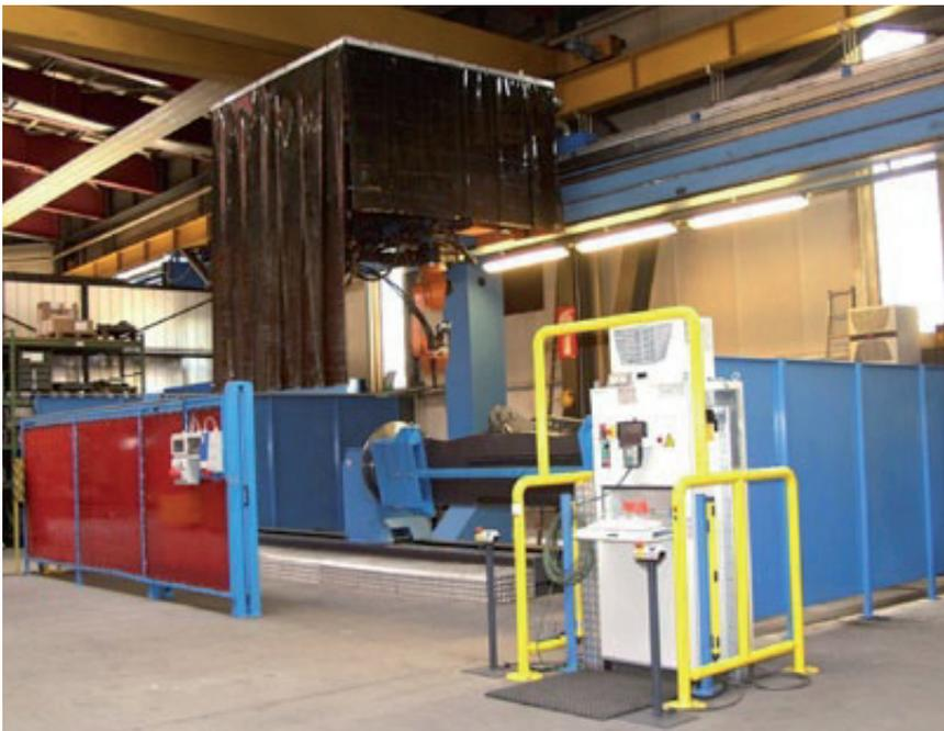
Le système de clôtures de protection Wand II en application dans une installation de soudage avec table réversible.
