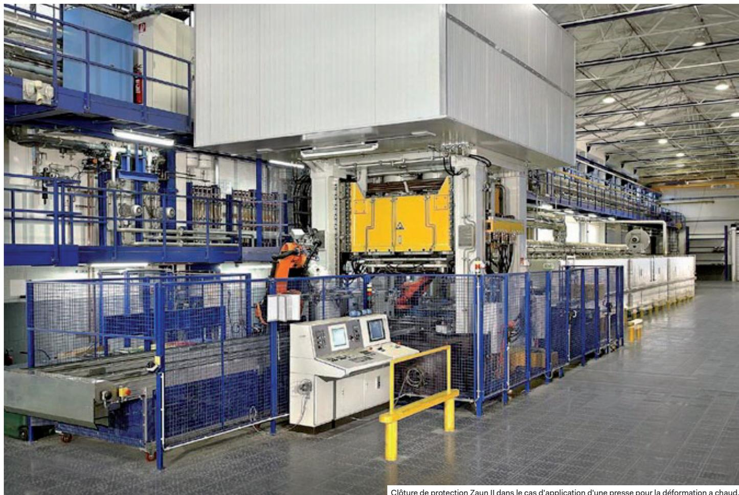
Clôture de protection Zaun II dans le cas d'application d'une presse pour la déformation à chaud.
