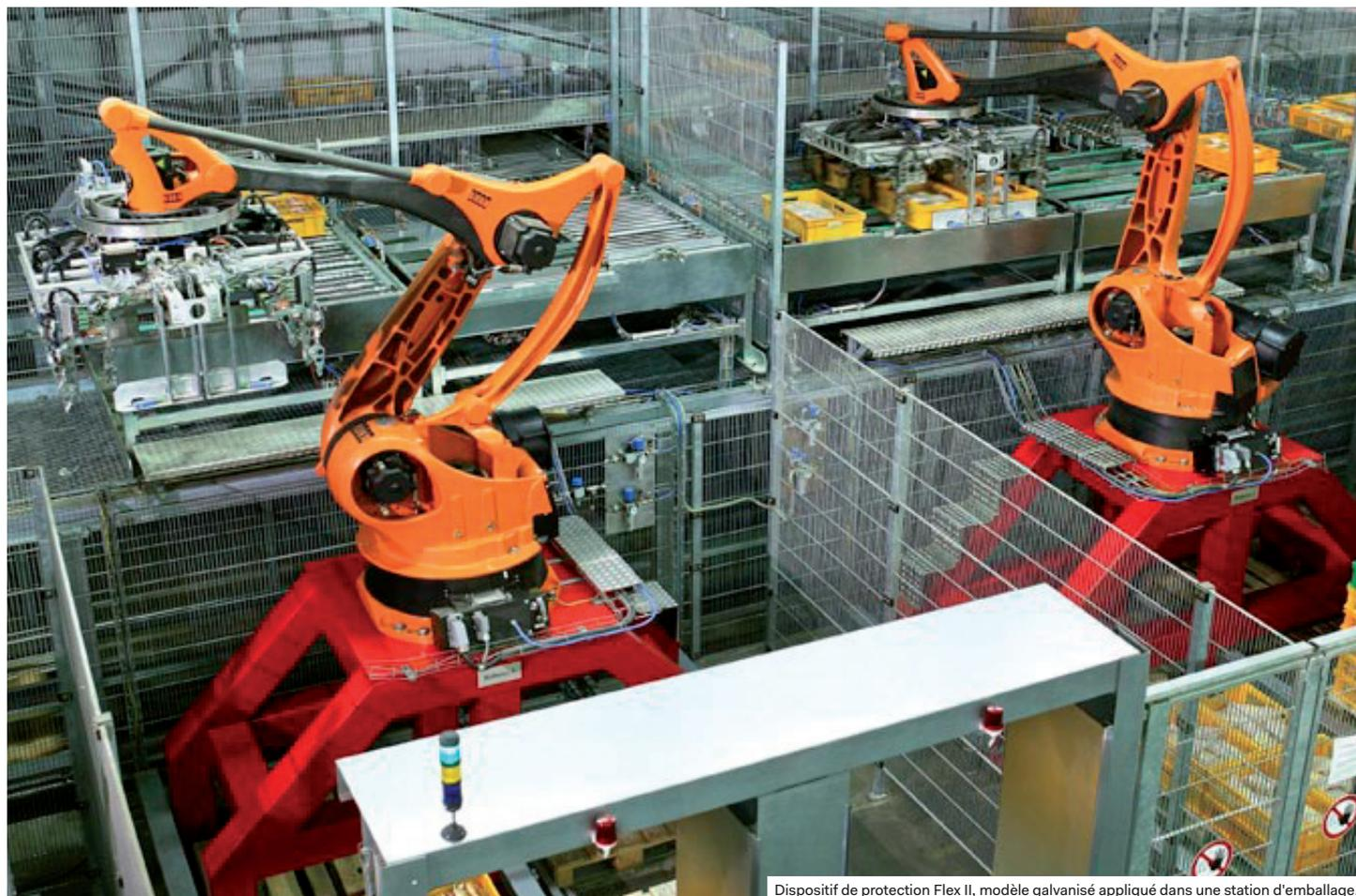
Dispositif de protection Flex II, modèle galvanisé appliqué dans une station d'emballage.
