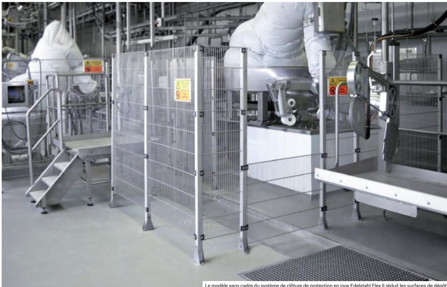
Le modèle sans cadre du système de clôture de protection en inox Edelstahl Flex II réduit les surfaces de dépôt.
