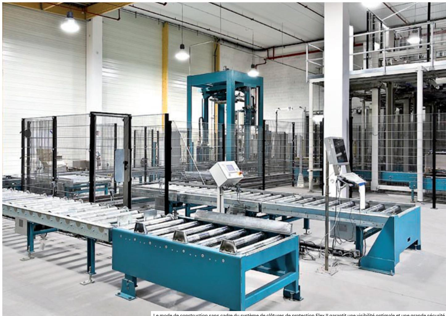
Le mode de construction sans cadre du système de clôtures de protection Flex II garantit une visibilité optimale et une grande sécurité.
